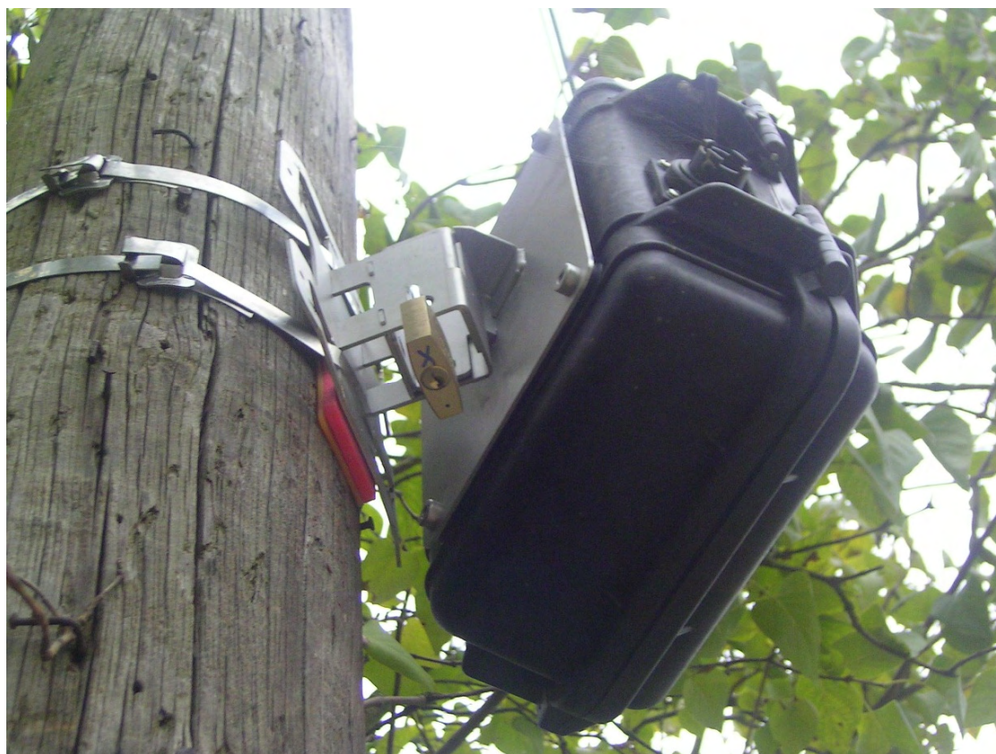
Figure 3 : Exemple de boîtier analyseur de trafic utilisé en 2010.
